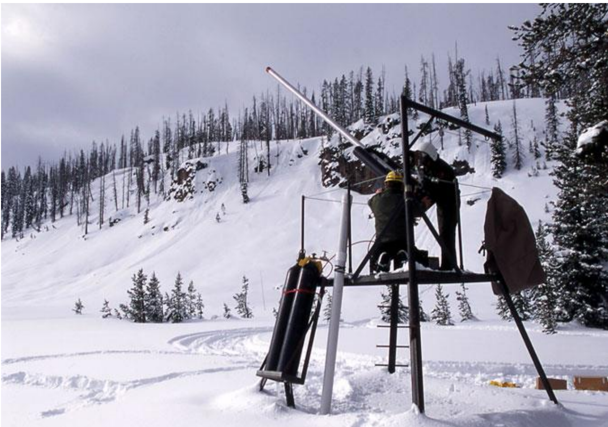
სურათი 3.5.3. პნევმატური ქვემეხი AVALAUNCHE .
