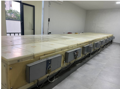
სურ. 1. არსებული ელექტრონიკა, დეტექტორი რომელზეც დატანლია 9 არხი, საიდანაც მიმდინარეობს კომპიუტერში ინფორმაციის გაგზავნა.
