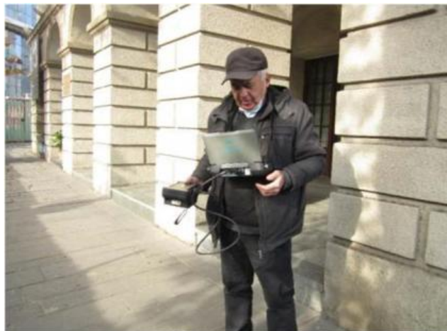
ნახ.16. ულტრაბგერითი ხელსაწყო Pundit – 200PE .
