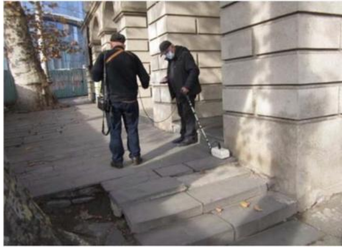
ნახ.7. წარმოდგენილია გეორადიოლოკაციური მეთოდით პროფილების შესრულების ფოტო გეორადარისზე მაღალი 2 გჰც მიმღებ-გადამცემი ანტენის გამოყენებით.
