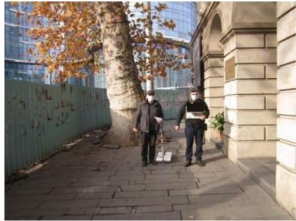
ნახ.1. წარმოდგენილია გეორადიოლოკაციური მეთოდით პროფილირების შესრულების ფოტო გეორადარის ეკრანირებული 500 მჰც მიმღებ-გადამცემი ანტენის გამოყენებით.
