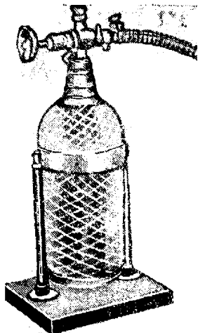
სურ. 66. სიფონი ზილის წვენის ჩამოსახმელად კიკებზე, წნევის კვეშ.
