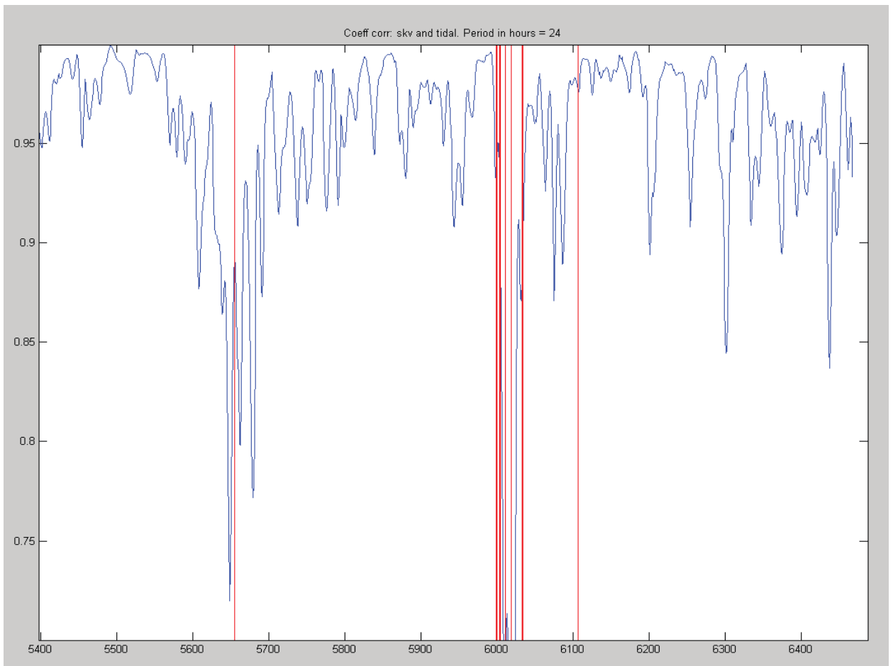
Рис. 5.12. Изменение коэффициента корреляции между уровнем воды и приливными вариациями. Вертикальные красные линии указывают на землетрясения.
