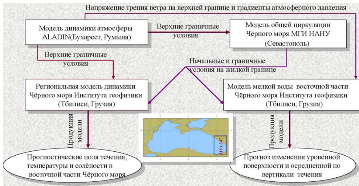
Рис. 2. Структура и схема функционирования региональной системы прогноза.
