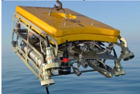
Рис. 1. Самоходный телеуправляемый подводный аппарат «Софокл-1».
