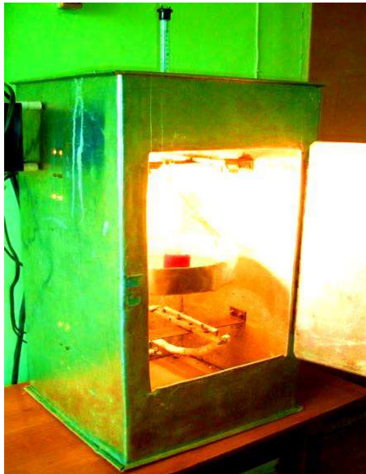
ნახ. 1 ინფრაწითელ სხივურ ენერგიაზე მომუშავე ექსპერიმენტალური დანადგარი
