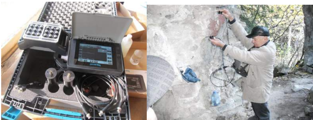
ნახ.2. ა. PUNDIT PL-200 და PL-200PE ულტრაბგერითი დეფექტოსკოპი ბ. სამუშაოები თისელის ტაძარში
