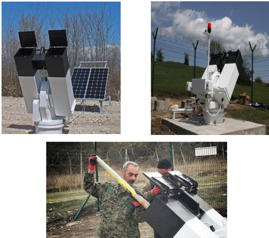
Рис. 24. Современная стационарная автоматическая пусковая установка «СД-26» с дистанционным управлением для противораковых ракет «SK-6», «Trayal D 6B», «Loza-2» производства научно-технического центра «Дельта» (Грузия) [45,46]
