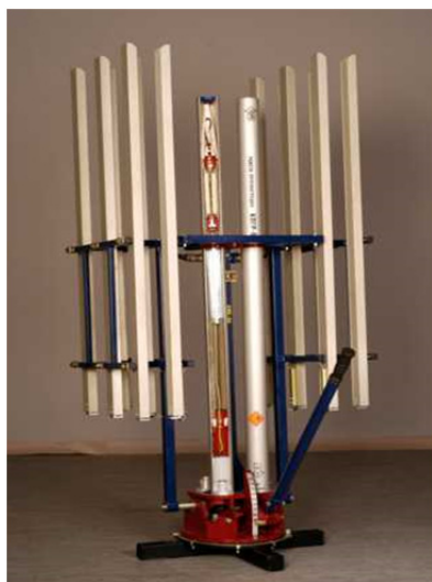
Рис. 13. Простейшая пусковая установка для противогородовых ракет «KRUSIK'S ANTI-HAIL SYSTEM (KPGS)» (слева) и Сербская автоматическая пусковая установка для запуска противогородовых ракет (справа)
