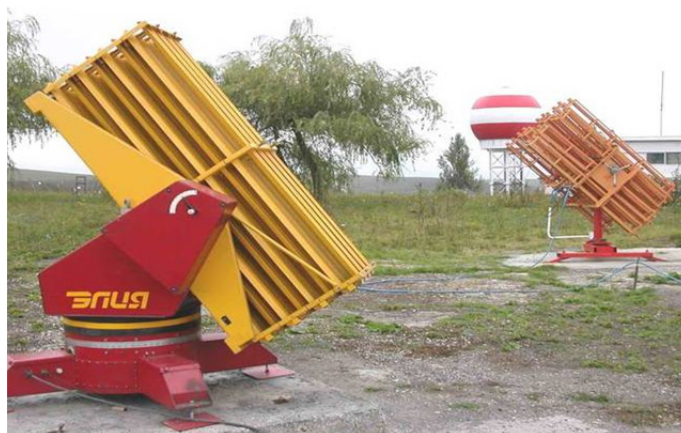
Рис. 2. Автоматизированная ракетная установка «Элия» (на переднем плане) и ракетная установка с ручным приводом «ТКБ-040-К» (на заднем плане).
