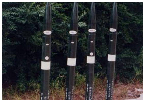
Рис. 19. Ракета «WR-98» для увеличения осадков и против града [43].
